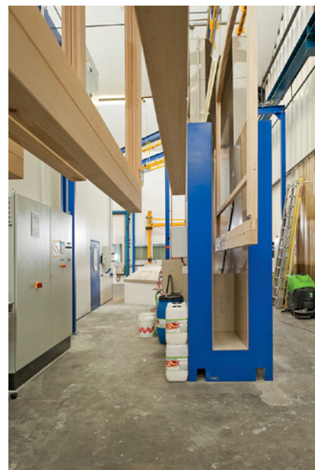
Automatische Fördersysteme transportieren die Fensterteile zu den Beschichtungsanlagen. Hinter der Flutanlage werden die Teile zum Abtropfen automatisch schräg gestellt.
